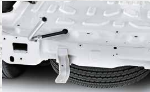
KOŁO ZAPASOWE DOSTĘPNE Z TYŁU I KOMPATYBILNE Z WIĘKSZOŚCIĄ WERSJI ZABUDOWY (OPCJA 980)
