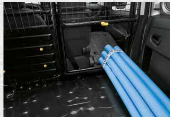
Przegroda wielofunkcyjna dla konfiguracji z 3 siedzeniami, zdejmowana po stronie pasażera, umożliwiającą przewóz długich przedmiotów
