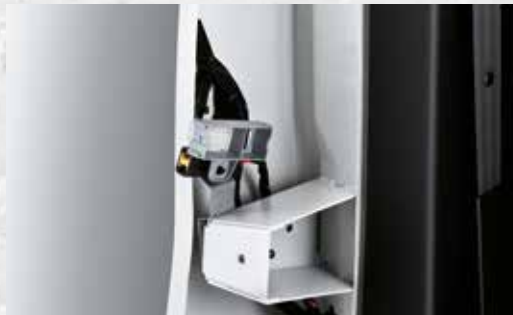
GNIAZDO TRANSFORMATORA – ELEKTRYCZNY INTERFEJS DO PODŁĄCZENIA WYPOSAŻENIA ZABUDOWY (OPCJA 081)
